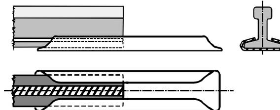
Die Laschen müssen eine sichere mechanische und erforderlichenfalls elektrische Verbindung gewährleisten und den Sicherheitsanforderungen entsprechen. Die Länge der Laschen soll etwa das Vierfache der Schienenhöhe betragen. Befestigte Laschen sind jeweils an der linken Schiene (von der Mitte des Gleisstückes aus gesehen) anzubringen.
